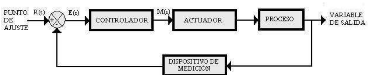
Figura 1.1 Sistema en lazo cerrado de control
