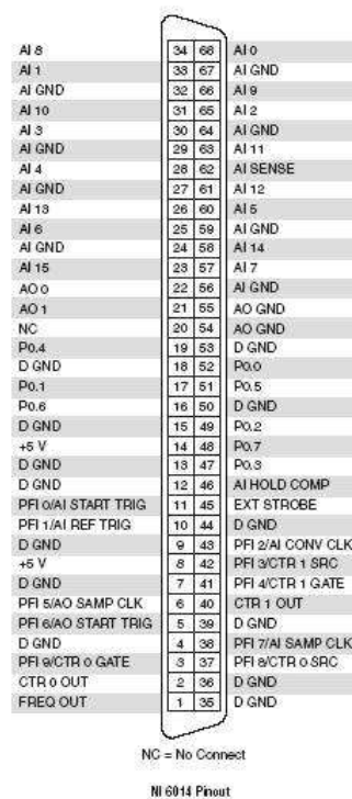
Figura 5.5 Conector I/O para dispositivos DAQ multifunciones básicos
