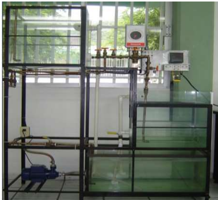
Figura 1.9 Presentación física de la estación de trabajo didáctica para la variable nivel
